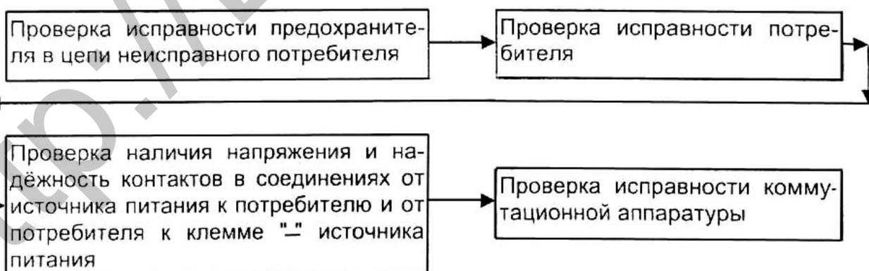
Для проверки электрооборудования используйте контрольную лампу или тестер (омметр и вольтметр). В качестве контрольной лампы применяйте лампу мощностью не менее 20 Вт (лампа А-12-21).
