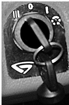
Рисунок 1.2 – Выключатель стартера и приборов
