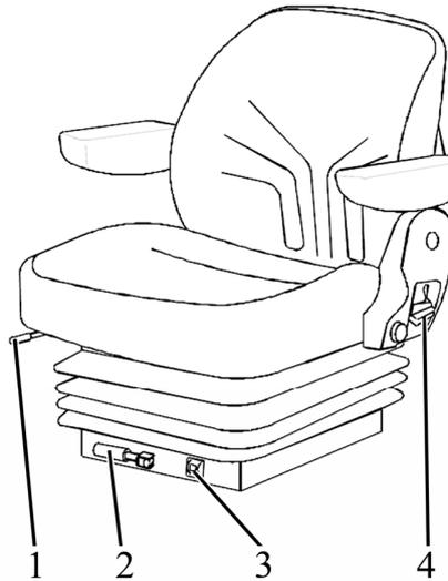
1 – рукоятка продольной регулировки; 2 – рукоятка регулирования по массе; 3 – индикатор регулирования сиденья по массе 4 – рычаг регулировки наклона спинки.
