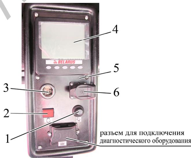
1 – кнопочный выключатель активизации диагностики; 2 – сигнализатор диагностики неисправностей; 3 – прикуриватель; 4 – монитор информационный; 5 – панель системы управления двигателем; 6 – розетка электрическая 12 В/ 25 А.
