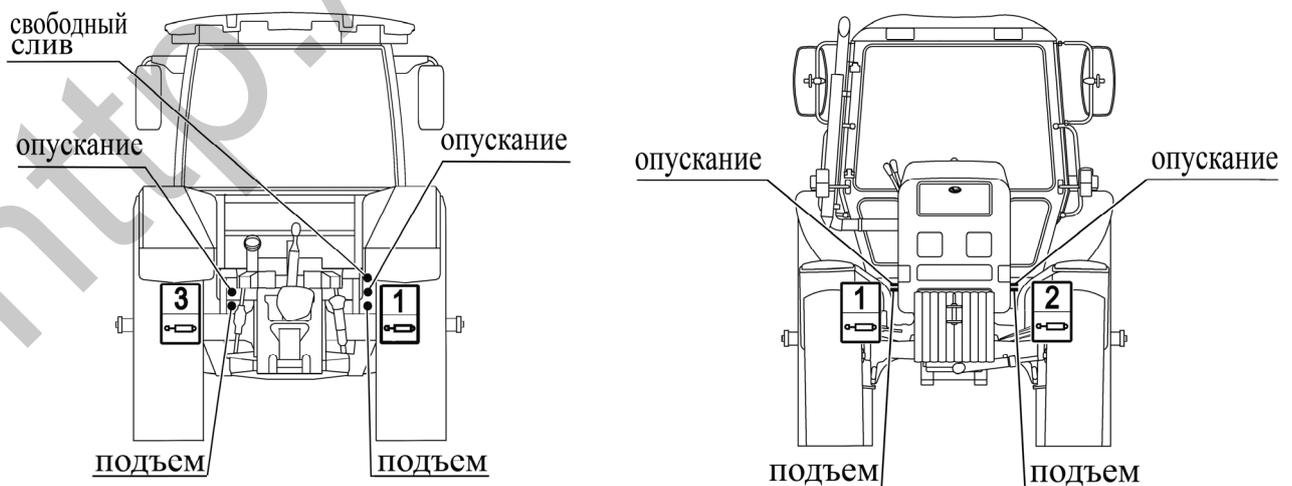
Рисунок 1.13 – Схема расположения и подключения выводов распределителя РП70-622 и РП70-622.1 к внешним потребителям
