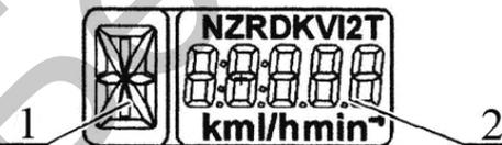
1 – цифровое обозначение положения переключателя коробки передач (цифры от 0 до 6) или буквенное обозначение положение переключателя редуктора (буквы L, M, H, N);
