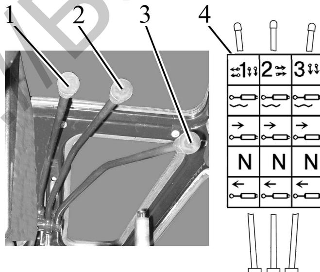
1, 2, 3 – рукоятки управления выводами распределителя ГНС (выносными цилиндрами); 4 – инструкционная табличка со схемой управления распределителем РП70-1221 или РП70-1221.1 или RS213Mita
