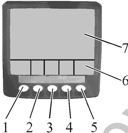
1 – кнопка вызова отображения основного индикатора и перебора индицируемых параметров; 2 – кнопка вызова четырехсекционного индикатора и перебора индицируемых параметров; 3 – кнопка вызова индикатора графического отображения и перебора индицируемых параметров; 4 – кнопка вызова индикации списка ошибок (неисправностей); 5 – кнопка входа/выхода в режим настройки контрастности, яркости и PIN – кода; 6 – сменное отображение назначений кнопок; 7 – экран.
