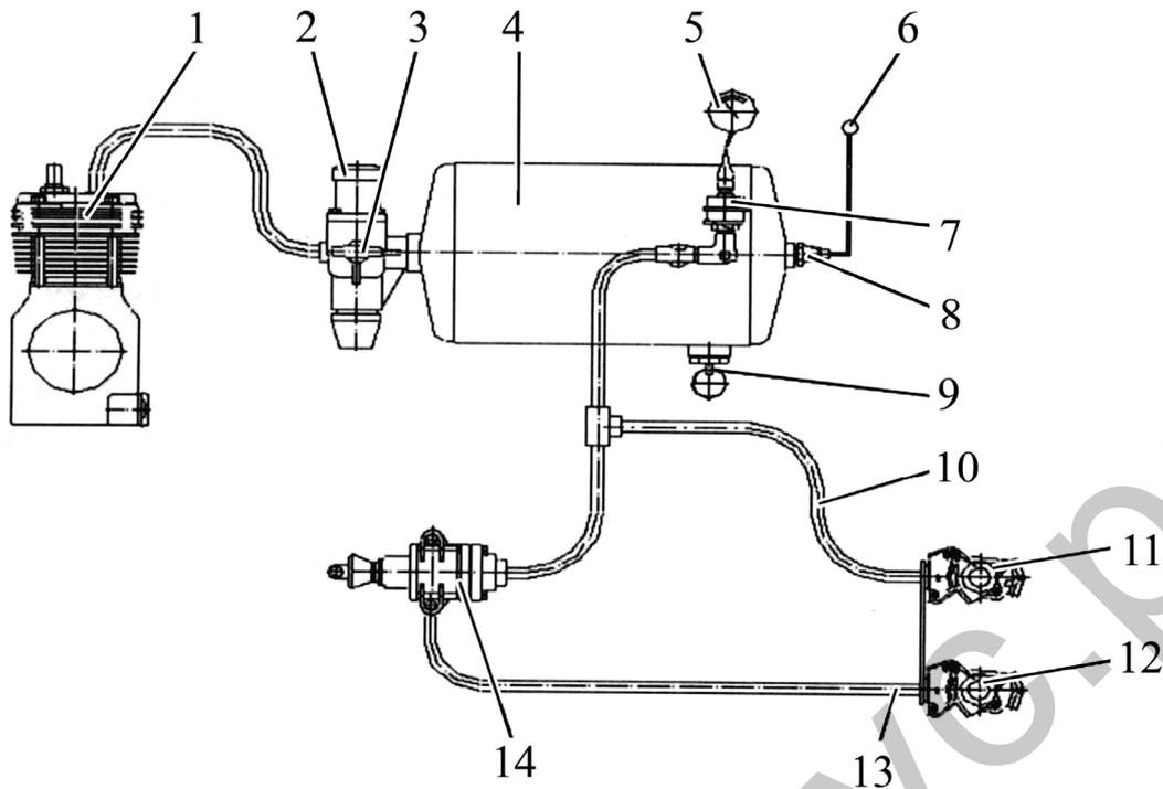
1 – компрессор; 2 – регулятор давления; 3 – клапан отбора воздуха; 4 – баллон; 5 – указатель давления воздуха; 6 – сигнальная лампа аварийного давления воздуха; 7 – датчик давления воздуха; 8 – датчик аварийного давления воздуха; 9 – клапан удаления конденсата; 10 – магистраль питания; 11 – соединительная головка магистрали питания (с красной крышкой); 12 – соединительная головка магистрали управления (с желтой крышкой); 13 – магистраль управления; 14 – тормозной кран.
