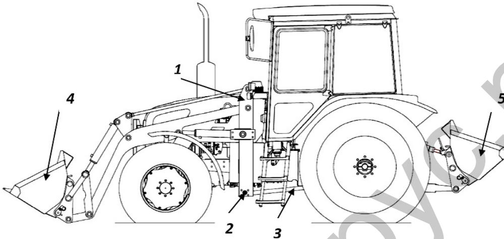
1 – комплект погрузочного оборудования для трактора; 2 – поперечная связка рамы погрузчика; 3 – тяга толкающая; 4 – ковш погрузчика; 5 – задний балластный груз.
