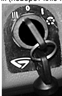
Рисунок 1.2 – Выключатель стартера и приборов
