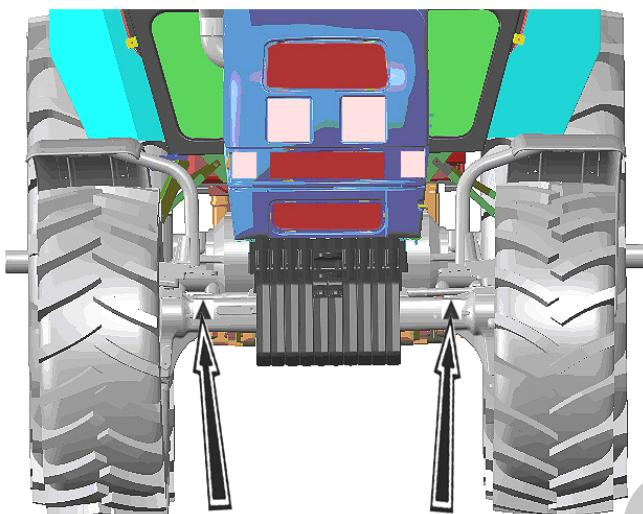
Рисунок 5.6 – Схема установки домкратов при подъеме передней части трактора
