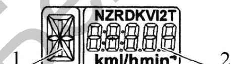
1 – цифровое обозначение положения переключателя коробки передач (цифры от 0 до 6) или буквенное обозначение положение переключателя редуктора (буквы L, M, H, N);
