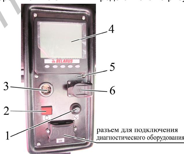
1 – кнопочный выключатель активизации диагностики; 2 – сигнализатор диагностики неисправностей; 3 – прикуриватель; 4 – монитор информационный; 5 – панель; 6 – розетка электрическая 12 В/ 25 А.
