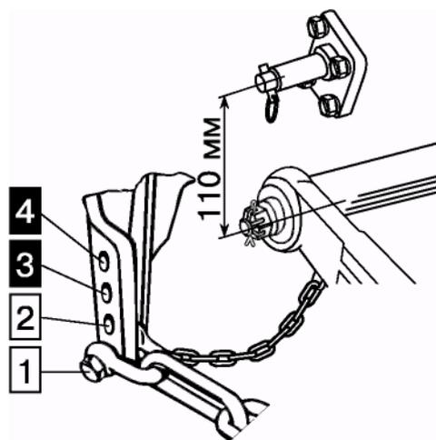
**ВНИМАНИЕ!** Стяжки должны быть установлены только на вторые снизу отверстия кронштейнов (положение 2), во избежание поломки стяжек.
