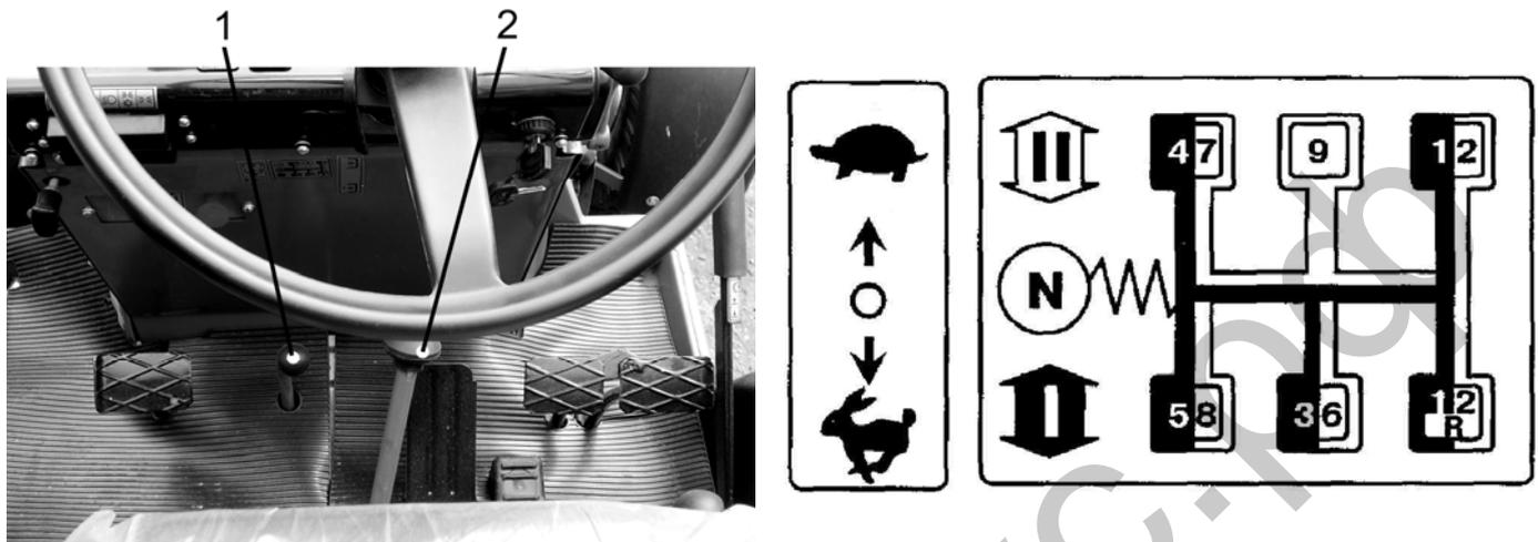
Коробка передач - 9/2 механическая с механическим понижающим редуктором. Переключение передач производится рычагом (2) в соответствии со схемой переключения. Прежде чем включить передачу, включите требуемый диапазон (ступень).
