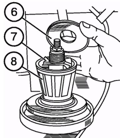
**ПРИМЕЧАНИЕ:** После остановки дизеля в течение 30-60 секунд должен быть слышен шум вращающегося ротора. Это указывает на то, что фильтр работает нормально.
