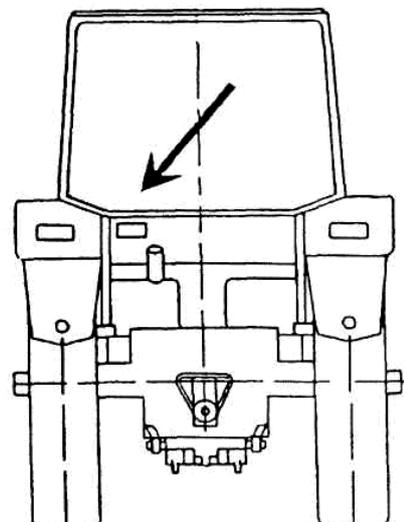
Серийный номер трактора дублируется на передней части правого лонжерона полурамы (или на правой пластине передних балластных грузов).
