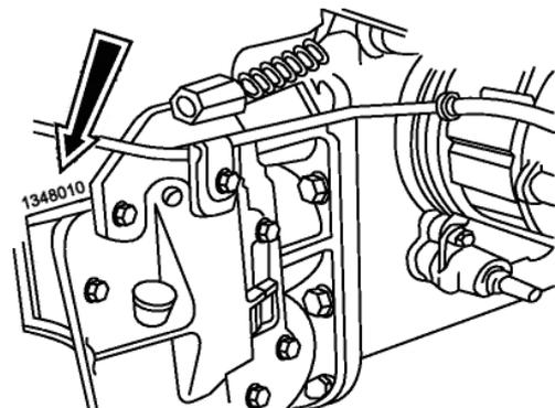
Номер трансмиссии (на корпусе заднего моста сзади).
