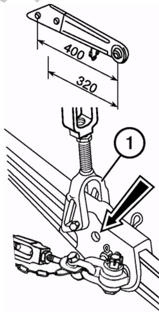
Для увеличения дорожного просвета при обработке высокостебельных культур установите передние концы нижних тяг на дополнительные оси подвеса, расположенные на 110 мм выше оси нижних тяг. Для копирования профиля поля в поперечном направлении при работе с широкозахватными орудиями соедините раскосы (1) с нижними тягами (2) через продольные пазы.
