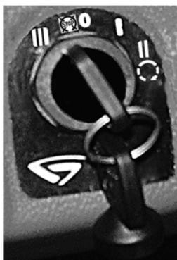
Рисунок 1.2 – Выключатель стартера и приборов
